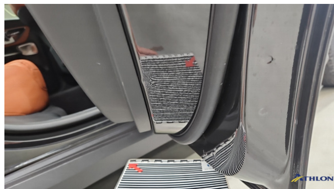
7. Tür Hinten - Rechts Verformt (leicht)
