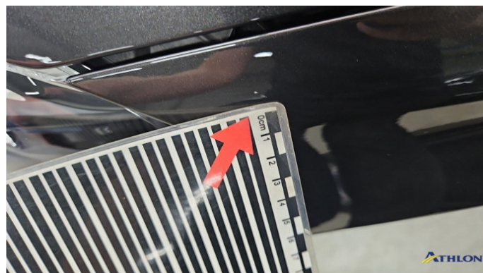
3. Kotflügel Vorne - Links Steinschlag
