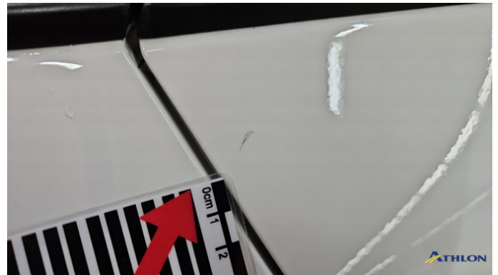
4. Tür Hinten - Rechts Kratzer
