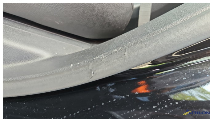
12. Türdichtung Hinten - Links Beschädigt
