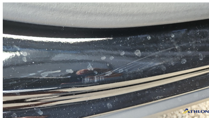
9. Türeinstieg Hinten - Rechts Kratzer
