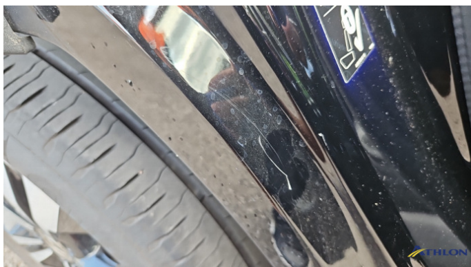
9. Türeinstieg Hinten - Rechts Kratzer
