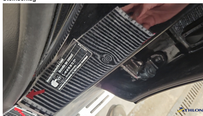
5. Türeinstieg Vorne - Links Verformt (leicht)
