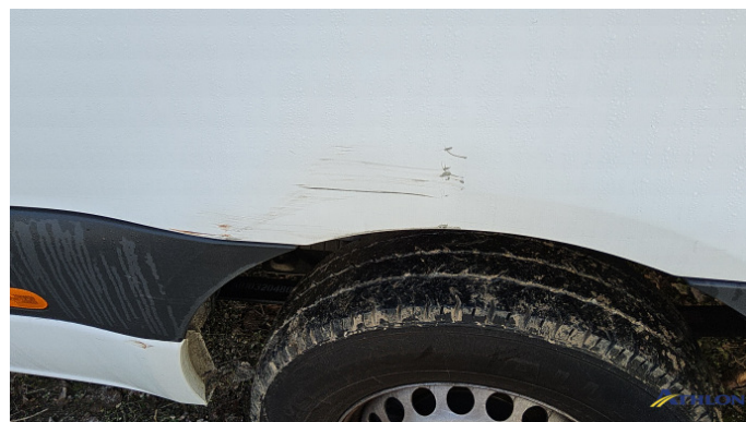
3. parete laterale - posteriore - sinistra 1 ammaccatura
