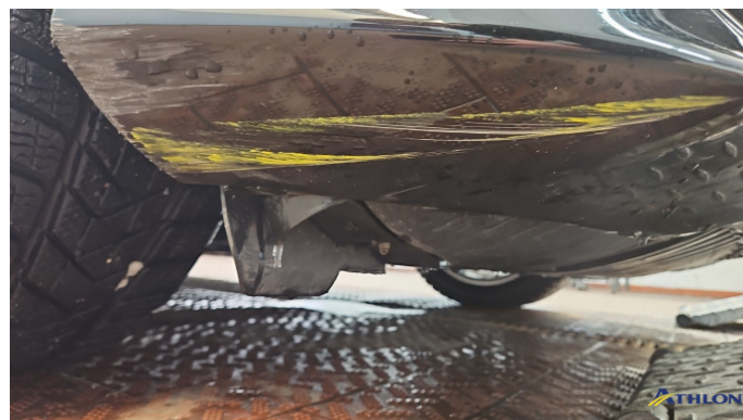
1. Stoßfänger Vorne Kratzer Ab 60mm
