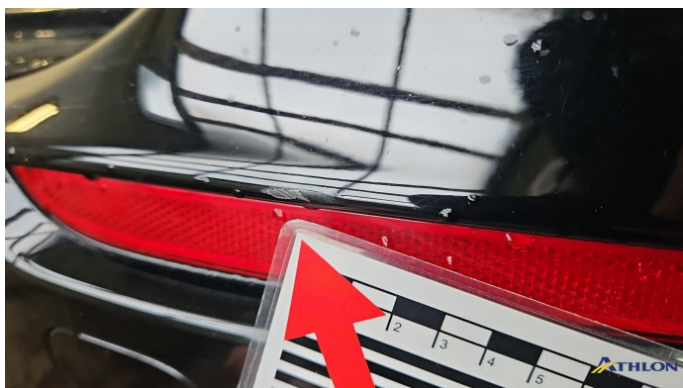
4. Stoßfänger Hinten Kratzer
