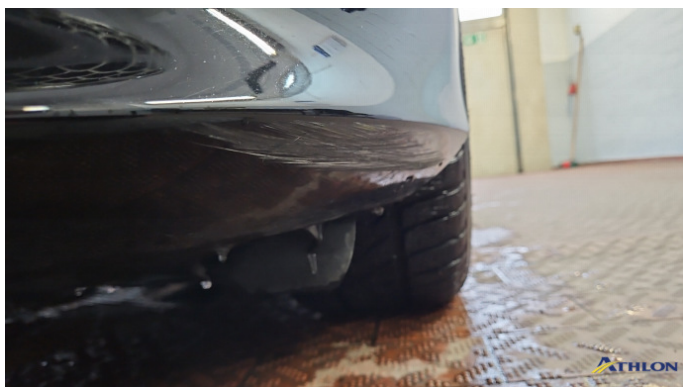
1. Stoßfänger Vorne Kratzer Ab 60mm
