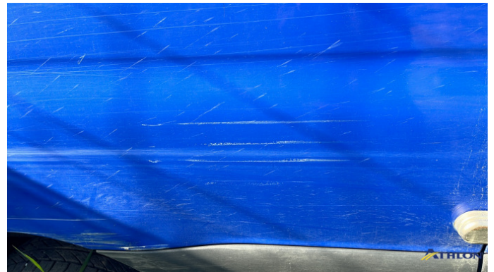
6. parete laterale - posteriore - destra Graffio/Rigature
