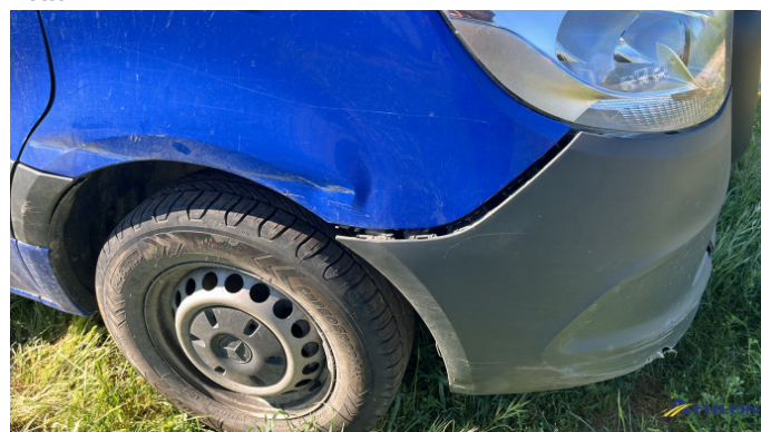
1. Parafango anteriore - destro Rotto
