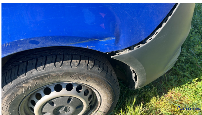
1. Parafango anteriore - destro Rotto
