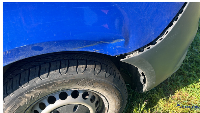
1. Parafango anteriore - destro Rotto
