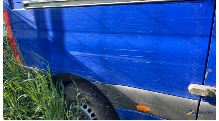
6. parete laterale - posteriore - destra Graffio/Rigature
