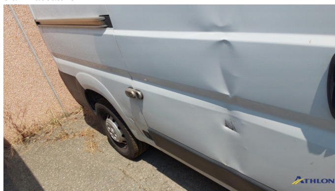
9. parete laterale - posteriore - destra Ammaccature/rigonfiamenti
