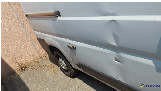
9. parete laterale - posteriore - destra Ammaccature/rigonfiamenti
