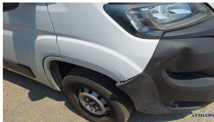
5. Parafango anteriore - destro Rotto
