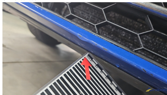
3. Stoßfänger Vorne Verformt (leicht)
