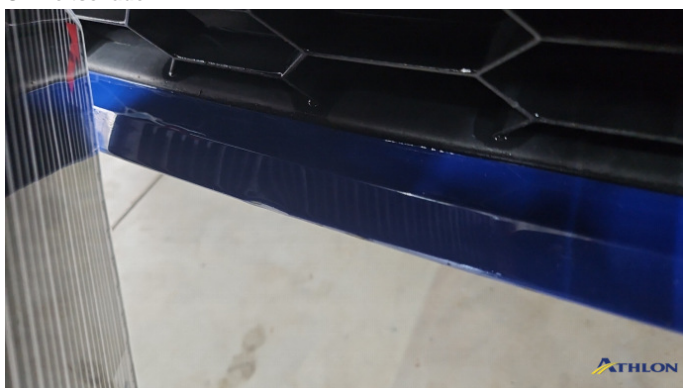
3. Stoßfänger Vorne Verformt (leicht)
