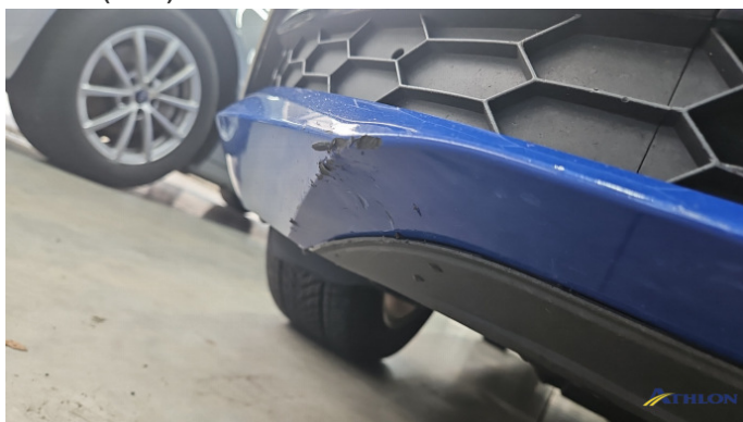
3. Stoßfänger Vorne Verformt (leicht)
