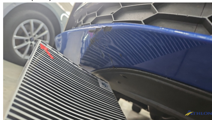
3. Stoßfänger Vorne Verformt (leicht)
