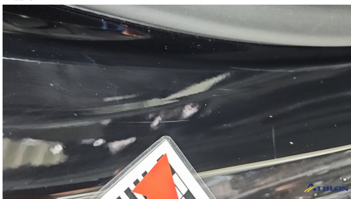
7. Türeinstieg Hinten - Rechts Kratzer
