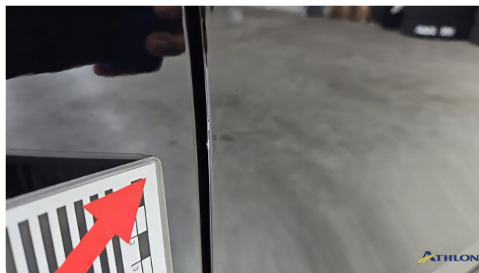
8. Tür Vorne - Rechts Kratzer
