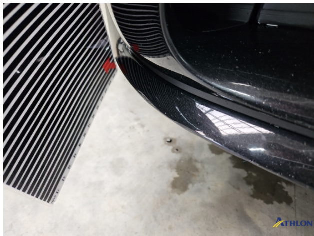
1. Stoßfänger Vorne Verformt (leicht)
