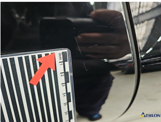
9. Tür Hinten - Rechts Kratzer
