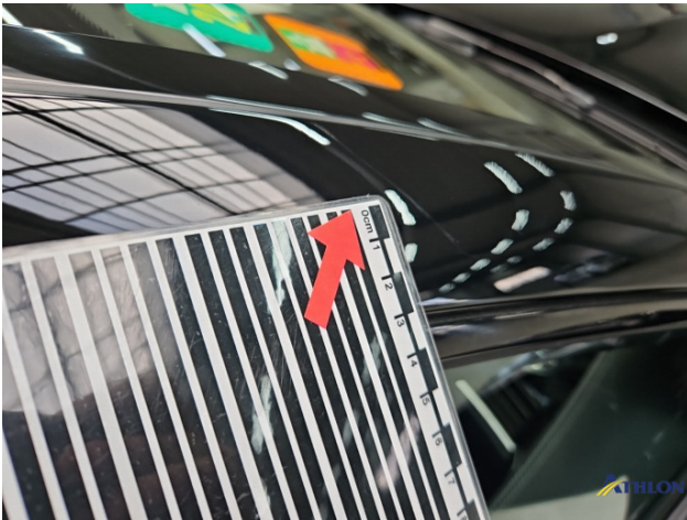
11. A-Säule Vorne - Rechts Kratzer
