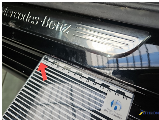
4. Türeinstieg Vorne - Links Kratzer
