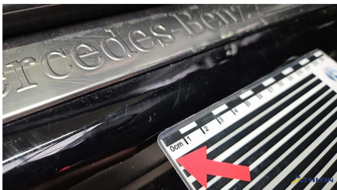
11. Türeinstieg Vorne - Rechts Kratzer
