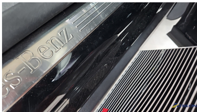
10. Türeinstieg Vorne - Rechts Verformt (stark)
