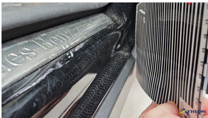
10. Türeinstieg Vorne - Rechts Verformt (stark)
